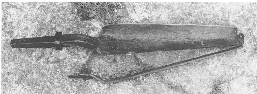
Skebor fra boresæt i Odsherreds Museums afdeling i Faarevejle. Det er 68 cm langt. Uden bøjle er det 10,5 cm bredt, eller 4 tommer, med bøjlen ca. 11,2 cm, men det kan gøres bredere ved at lægge noget mellem bøjlen og boret.
