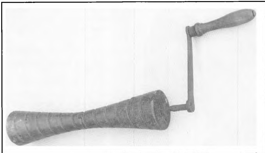
Fjederbom til drejning af møbelfjedre - købt for 20 kr. på et privat loppemarked, hvor man solgte restlageret fra en tidligere københavnsk antikvitethandel.
