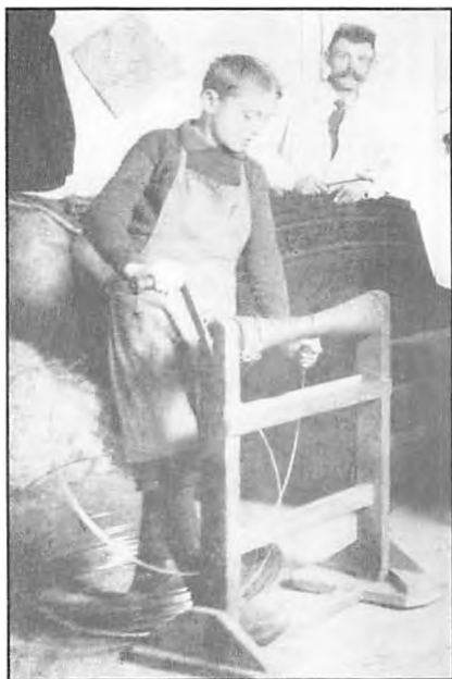
Læredrengen drejer den spiralformede møbelfjeder, "hjertefjederen", på møbel-polstrerens værksted. Foto fra ca. 1890, gengivet fra den citerede bog.
