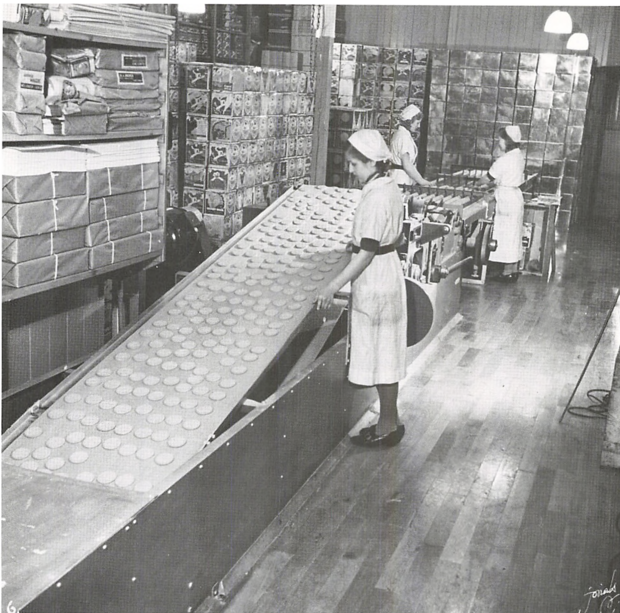
De færdigbakte kiks bliver her på afkølingsbåndet kontrolleret for eventuelle fejl og derefter ført over til en sorteringsmaskine, hvor et par medarbejdere pakker de stablede kiks i kasser.
