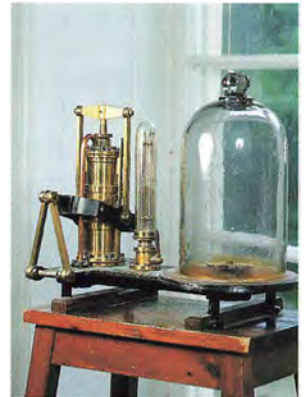
Apparatur fra fysikundervisningen på katedralskolen fra o. 1900. Øverst polarisationsapparater, nederst luftpumpe til at frembringe lave tryk.
