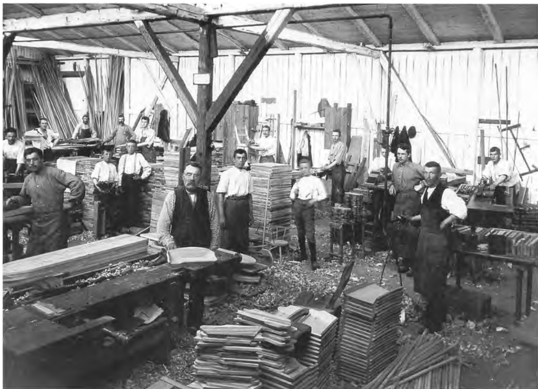
Chr. Riegels Trævarefabrik o. 1906. Her er der tale om en vis industriel arbejdsdeling, idet de enkelte arbejdere kun udfører en delfunktion. Her finpudser og samler de alene de strygebrætter og brødbakker, som andre maskinelt har skåret til i en anden fabriksdel.
