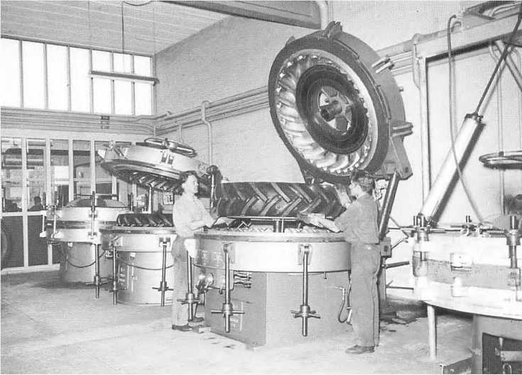
Fremstilling af store traktordæk på Viborg Slidbanefabrik i 1960. Efter at de gamle slidbaner var raspet af, blev der lagt en vulkaniseringscement på, derefter rågummimasse, og så kom dækkene til slidbaneformene, som ses på billedet. Foto: Lokalhistorisk Arkiv for Viborg kommune.
