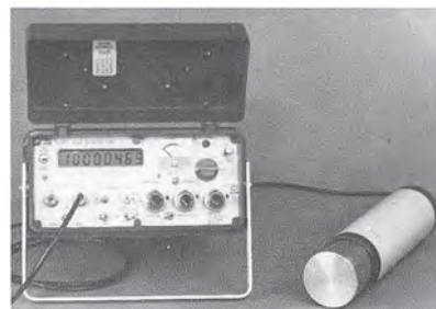
Fig. 1. Apparat (scintillationstæller) til måling af baggrundsstråling. VM fot.
