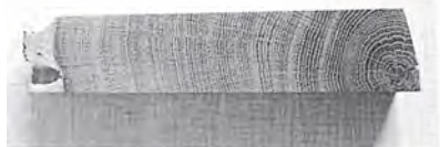
Fig. 3. Udsnit af stolpe fra broanlæg ved Skindens bro (nr. 999). Den yngste splintvedsår-ring ved barken er dateret til 1649. Træet har vokset i perioden 1496-1649. Wormianum fot.
