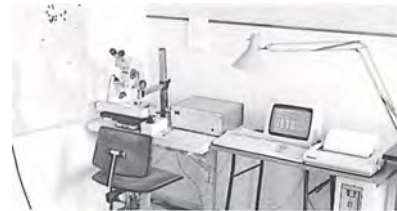
Fig. 2. Apparatur til årringemåling tilsluttet en datamat. Wormianum fot.
