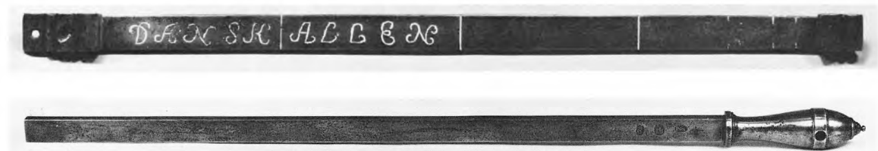
Fig. 2. Øverst: Alenmålet, der bærer tydelige spor efter mange års ophængning i jernkæde, er ikke delt i 24 tommer, men i 4 kvarter og ved fortsat halvering i 8-del, 16-del og 32-del. Prunkskriften med kursive versalier var meget yndet omkring 1650. Københavns Bymuseum. Svend Sørensen fot. Nederst: Denne stål-alen bærer inskriptionen „Givet af Etatsraad og Raadmand Voltelen 1820“. Den blev ophængt på rådstuens børs, dvs. rådhusbetjentenes vagtstue. Københavns Bymuseum. Svend Sørensen fot.
