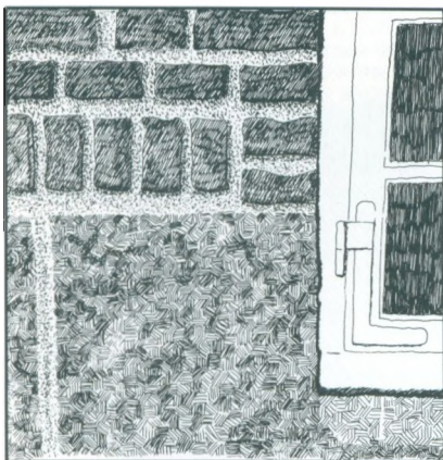
Granitsoklen i tilhuggede blokke. Bemærk den udhuggede »sålbank« og murværket.
