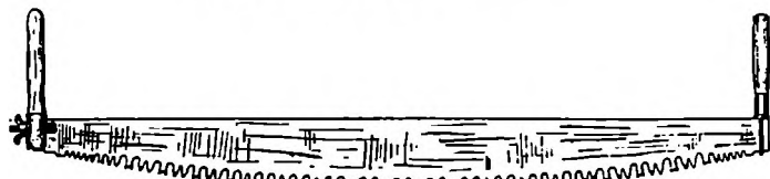
8. Disstonsav. Den lille figur viser skæreprincippet for Disstonsaven. Efter »Lærebog for skovfogedelever« 1950.
