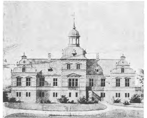
F. Meldahl: Hovedbygningen på Stubbarp ved Arildsleje på Kul-len; omkr. 1851-52. De fem dele af forsiden er hver 10 alen. Den øverste del af tårnet er det halve af den nederste del over kælderen. Tårnets gesims flugter med tagryggen bagved.
