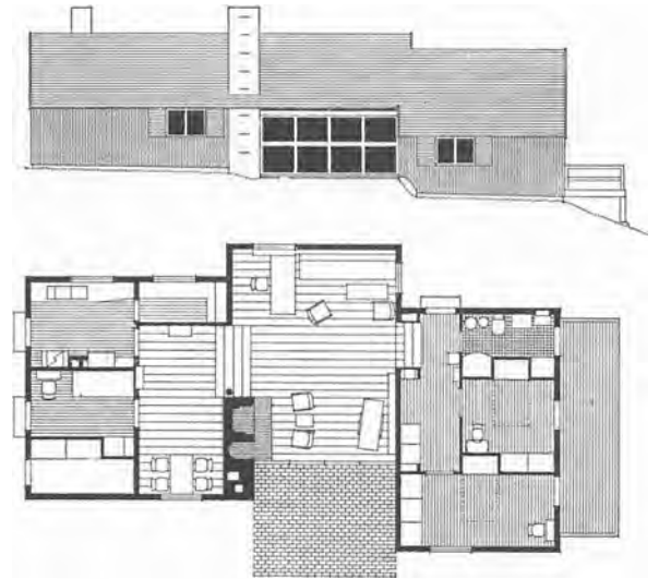
Ole Hagen: Eenfamiliehus i Rungsted, 1942. 1:250. Tømmerkonstruktion med bræddedækning; taget dækket med træspån.
