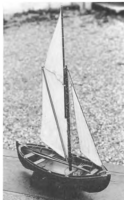
På denne model ses snekkerstenjollen med de smukt rundede former og den klassiske sejlføring med stormast, topsejlstage og sprydstage. (Fiskerne, Flynderupgård).
