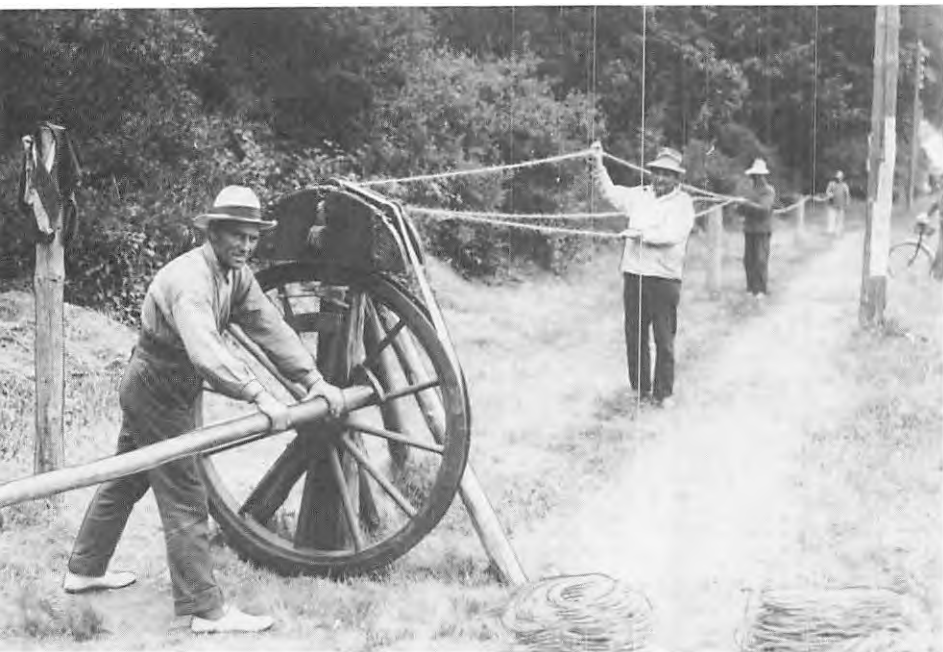
Der slås tovværk på Humlebæks reberbane ved Babyloneskoven omkring 1920. Det er sommer, for rebslageren ved hjulet, der slår de tre kordeller sammen, har hængt vesten fra sig på stejlen til venstre. (Det kgl. Bibliotek).
