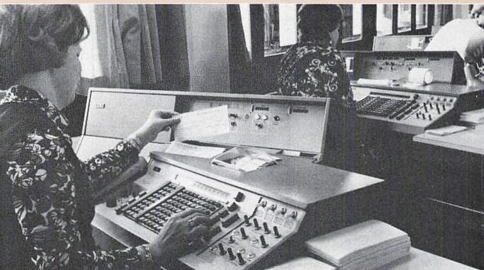
Datafangsten sker for checkenes vedkommende fra 1965 med magnetkodeskrift. Her vises indkodning på »NATIONAL 481«.
