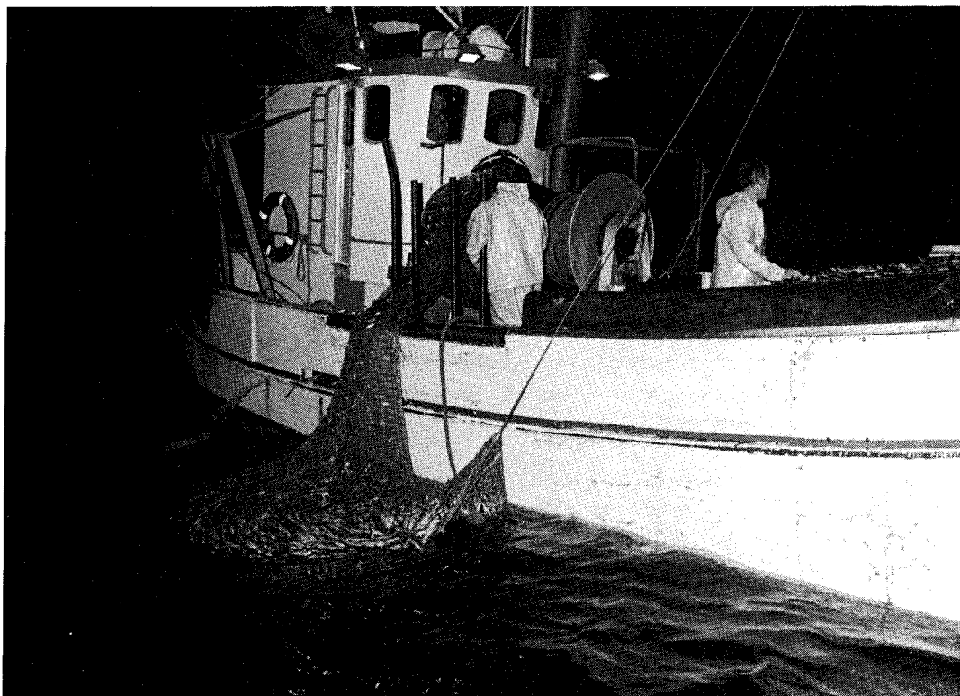
Trawlfiskeri efter sild med R 279 "Codan", der slæber dobbelt med R 103 "Bianca". Når der hales med trawltromlen, pressen fisken ud i "løftet" for enden af trawlposen. Det fyldte løft taljes herefter ombord, og indholdet lukkes ud på dækket. Foto: P. H. Moustgaard 1985.
