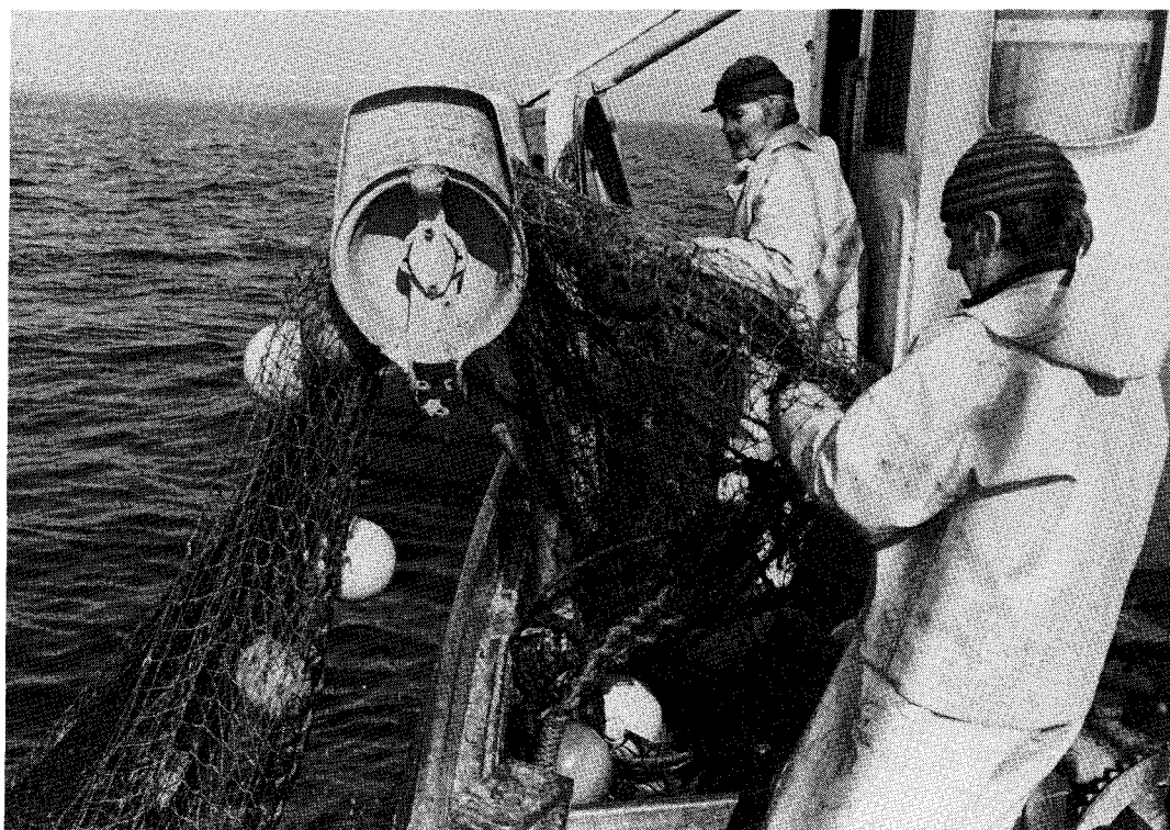
Indførelsen af hydraulik og kunstmaterialer til erstatning for bomuldsgarnet muliggjorde en voldsom effektivisering af fiskeriet. Her benyttes kraftblokken til optagning af trawlposen under fiskeri efter torsk med SE 115 “Dana” af Listed. Foto: P. H. Moustgaard 1985.
