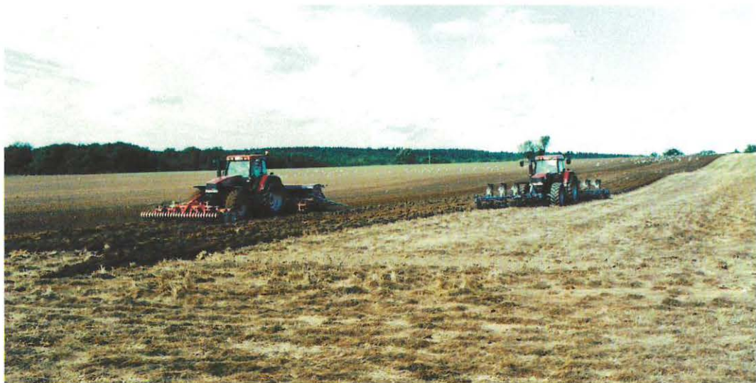
I 2005 foregår pløjning og såning ofte med to traktorer lige efter hinanden. Den ene traktor er monteret med tre pløjelegemer foran og fem pløjelegemer bag på traktoren. Den anden traktor har harven monteret foran og såmaskinen og efterharve bag på. Foto hvor Nexøvejen skæres af Grødby Å, Henrik Vensild 2005, Bornholms Museum.
