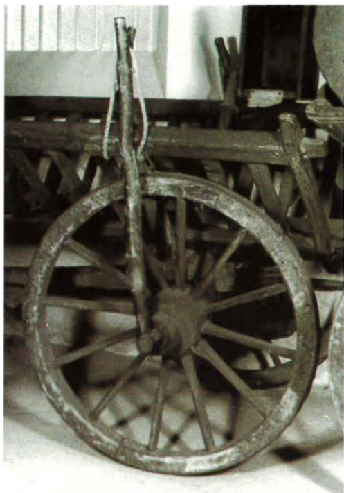
Vi hører om en »Arbejdsvogn med Høestier« en sådan findes stadig og kan normalt ses på Melstedgård. Her findes den også i kopi og bliver brugt af og til. Høestier hentyder til vognens sider, der ligner to stiger. Fra hjulhavene går der stænger op til vognsiderne. Det er et østeuropæisk træk. Foto Bornholms Museum.
