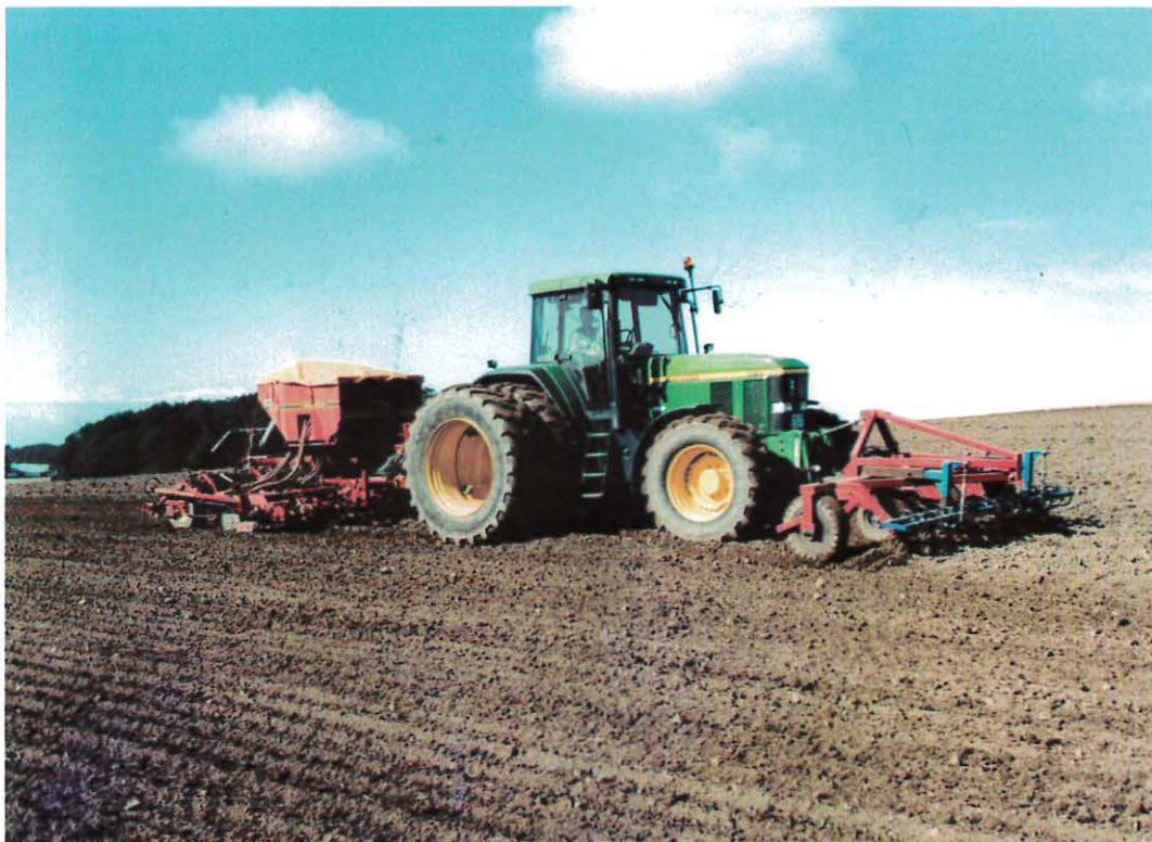
Kort efter sår man vintersæden, hveden med en kombineret så- og jordbehandlingsmaskine, så det hele er gjort i én arbejdsgang. Foto Henrik Vensild 2004.
