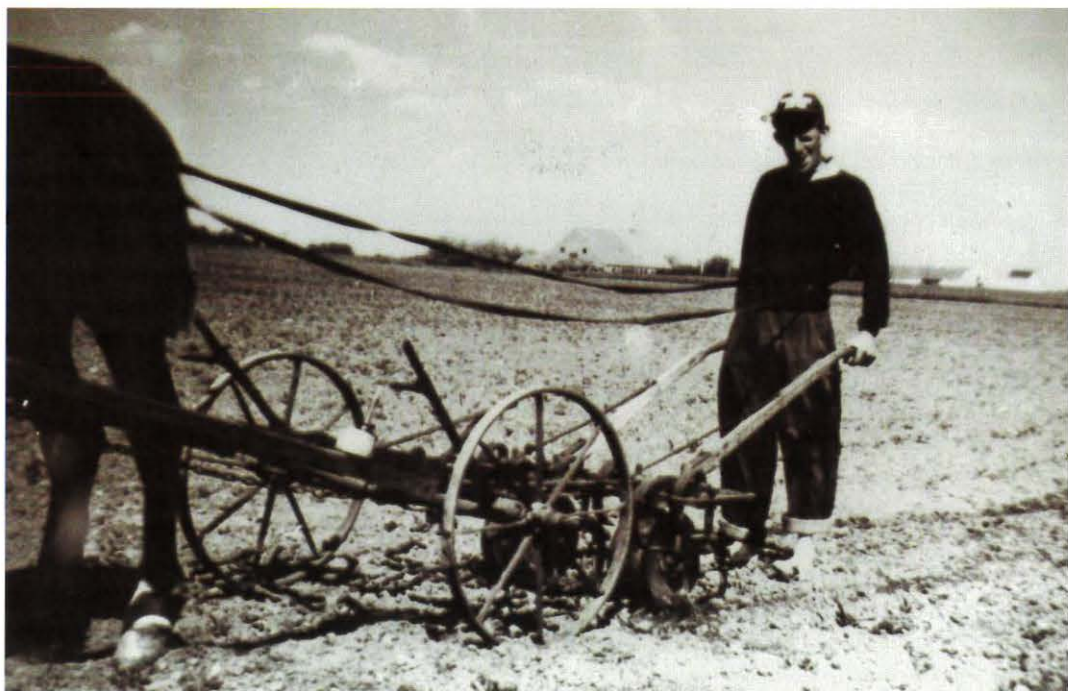
Fig. 4. Vi hører meget om hvad radrenseren har betydet for renholdelse af markerne. Her er det en renser fra Bornholms Maskinfabrik der renses roer med på St. Loftsgård, men på Aspesgård var det en Fraugde-radrenser man havde. Foto Pedersker Lokalforening.
