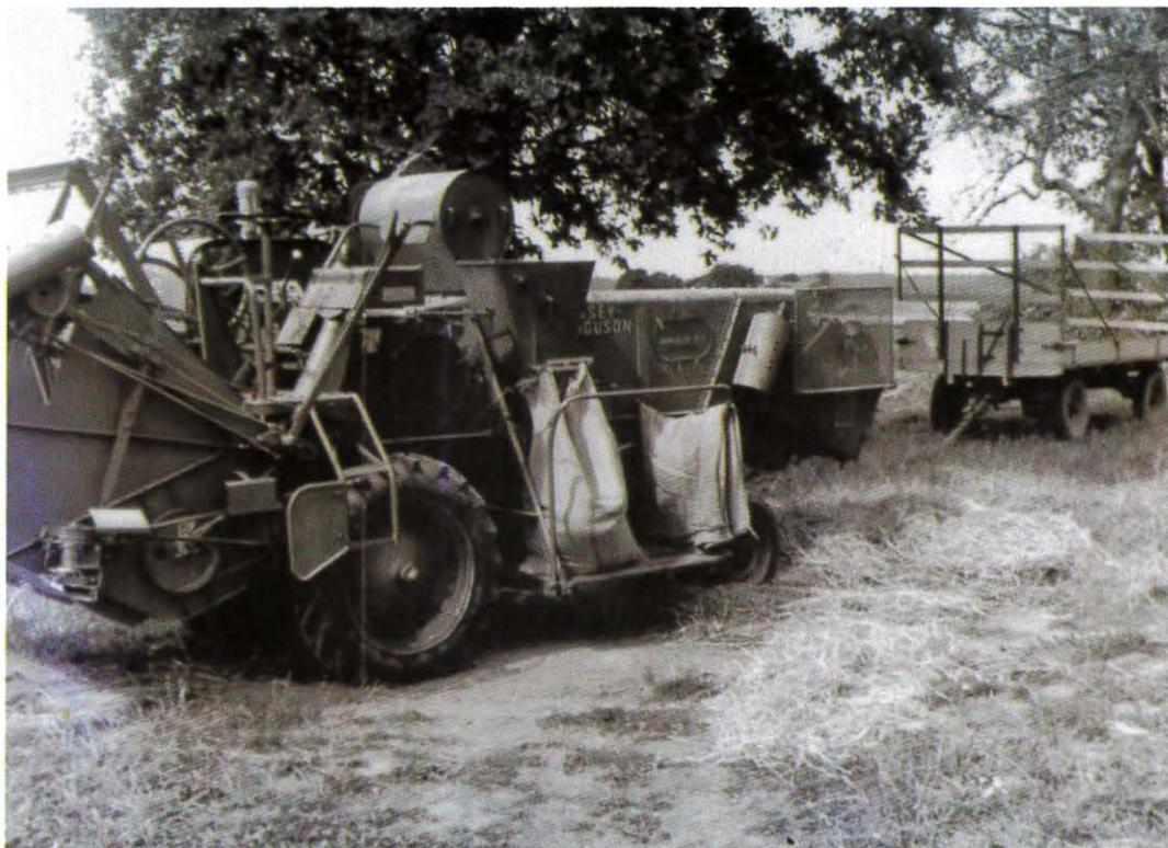
Den første mejetærsker blev anskaffet i 1961. Det var en lille selvkørende Massey-Ferguson på 6 fod, både til sække og med korntank. Bag ved ses gummivognen, fremstillet hos Ejner Jensen i Nexø, med »høstegavle« på. Foto i privateje.
