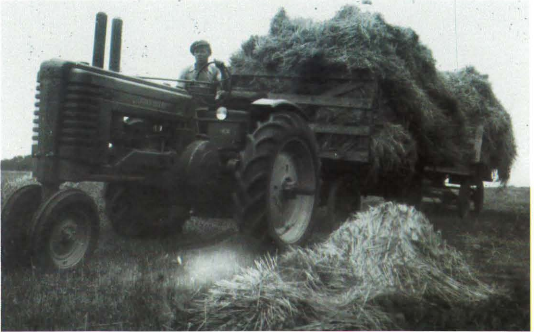
Jarl Sonne på »sin« John Deere traktor model A. I høstens tid med et par ikke særlig vellagte kornlæs bag efter. Man ser, at baghjulsakslen stikker ud fra hjulet. Så man kunne stille hjulbredden efter hvilke opgaver traktoren skulle udføre. Men man kunne også vælte hegnspæle og andet, hvis man ikke tog sig i agt for de udragende bagaksler. Foto i privateje.
