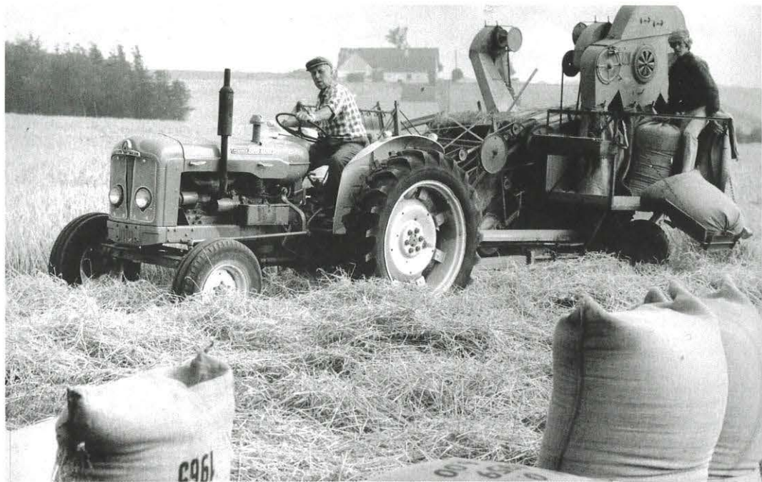
Med mejetærskeren flyttede hele høstarbejdet ud i marken. En lille Dronningborg sækkemaskine trækkes her af en Fordson Super Major. Der er kraftoverføring til mejetærskeren. Arbejdet kræver stadig to mand og så skal halmen opsamles og presses bag efter, hvis ikke den brændes af direkte på marken. Foto Gert H. Jørgensen, Bornholmeren 1972, Bornholms Museum.
