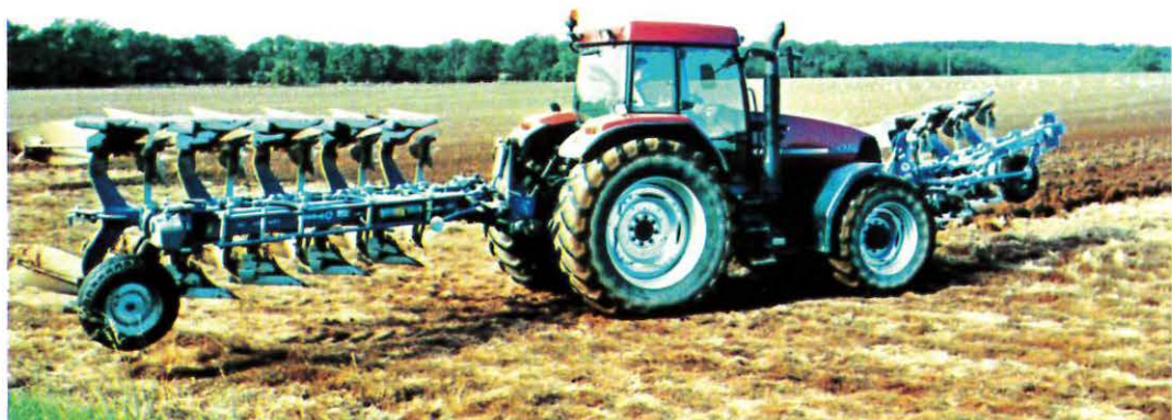
Pløjning ved Nexøvejen, nær Siegårdvej i efteråret 2005. Her kører en stor Case med en 8 furet vendepløj, hvor de 3 furer er frontmonteret. Der er langt til fortiden kan man synes, men marken er den samme. Foto Henrik Vensild 2005.
