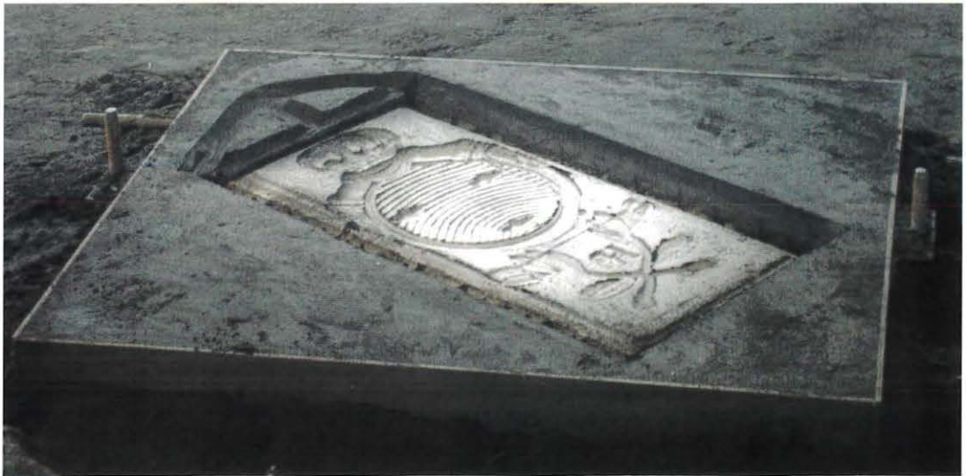
Med en træpatrice er der blevet fremstillet en matrice i støbesand, som nu er ved at blive gjort klar til støbning på Ebbamåla Bruk. Det er en gavlplade med det lille svenske rigsvåben med tre kroner. HB (spejlvendt) mellem de to korslagte grene står for Huseby Bruk. Foto Niels-Holger Larsen, 2007.
