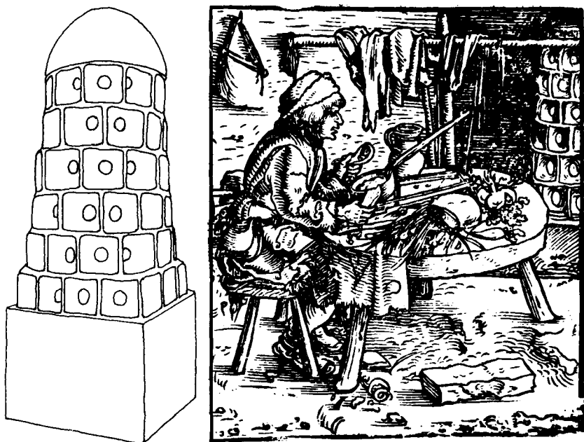
Fig. 1a. Rekonstruktion af ovn, opført af pottetekakler. I den murede, firsidede underdel har der været indfyring, rimeligvis efter bilægger-princippet fra et tilstødende rum, idet man må forestille sig ovnen placeret op ad en væg eller i et hjørne. Ef. Liebgott; p. 6. Tegning Birgit Als-Hansen.
