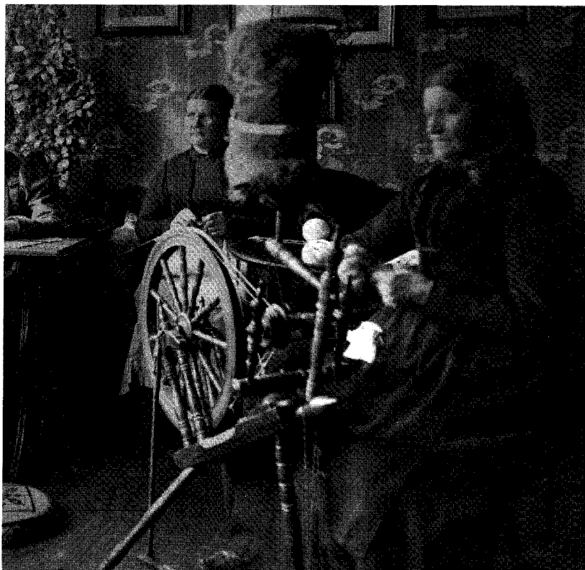
Fig. 3. Hørspinding. Hørren er bundet med et rokkebrev på bruehovedet, en opstander på rokken.
