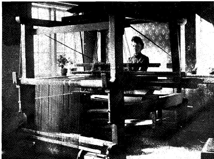
Fig. 3. Interiør fra drejlsvæver, enkemadam Bidstrups hus i Stettestræde i Rønne. Ved denne væv og i denne stue lærte Kristine at væve drejl. Væven er større og mere veludstyret end de almindelige »bondevæve«. Man aner, at denne væv er udstyret med kontramarch og to sæt sideskamler. Med denne vævetype kan man væve mere komplicerede vævemønstre. Foto fra 1890'erne.
