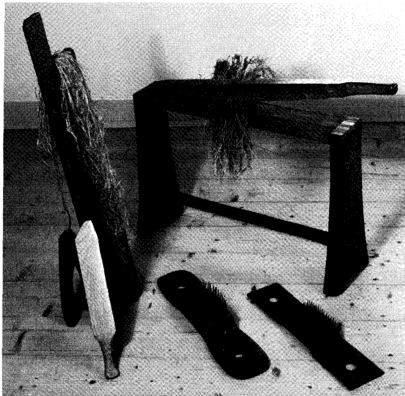
Fig. 2. Bornholmsk bryde, skættefod og skættetræ, samt to slags hegler, en med finere og en med grovere pigge.
