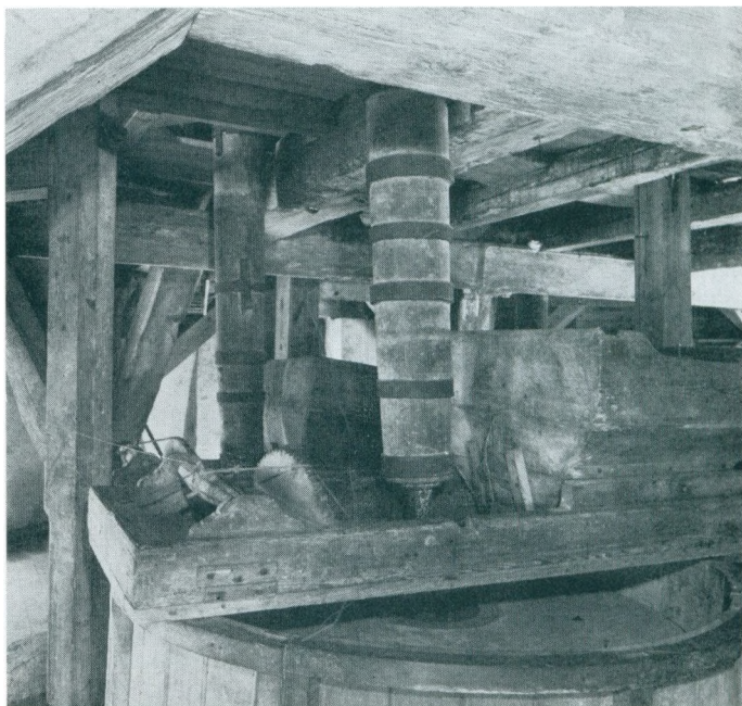
Fig. 7. På kværnloftet trækker de to lodrette akser med jernringene kværnene. En akse-jern ender i et bundspor, hvor akseu hviler på kobber-femore.
