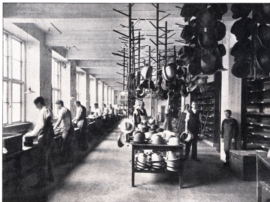
Façonnering af Straahatte.
