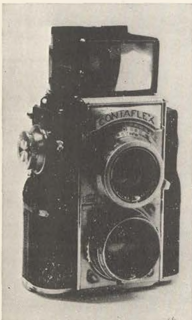
Contaflex (1935) kombination af et 2-øjet kamera og 24 x 36 formatet i forbindelse med udskiftelig optik og indbygget foto-elektrisk lysmåler. Vægt: Næsten 1½ kg.
