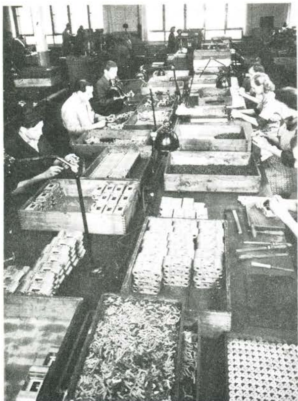
Afgratning af trykstøbte kamerahuse.
