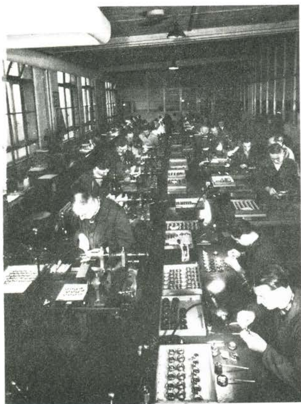
Optisk værksted hvor linseelementerne samles i fatninger.
