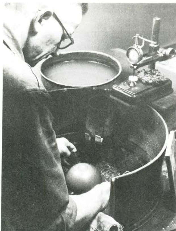
Efterjustering af linsetykkelse sker her ved at holde en linse mod en roterende kugle med lappetkorn på.
