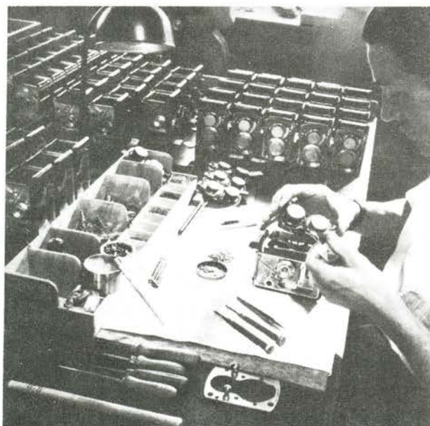
Montage af de to objektiver.
