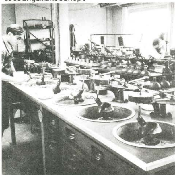
I linsesliberiet, hvor de opkittede linser slibes i kugleform.
