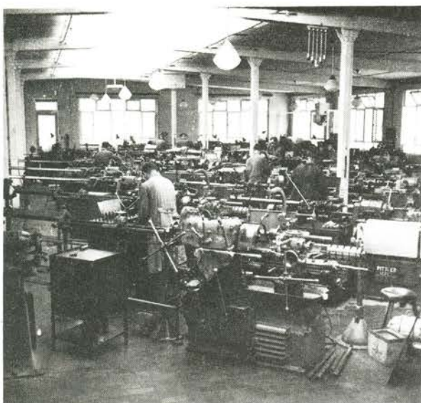
Drejeværksted med revolver- og automatbænke.
