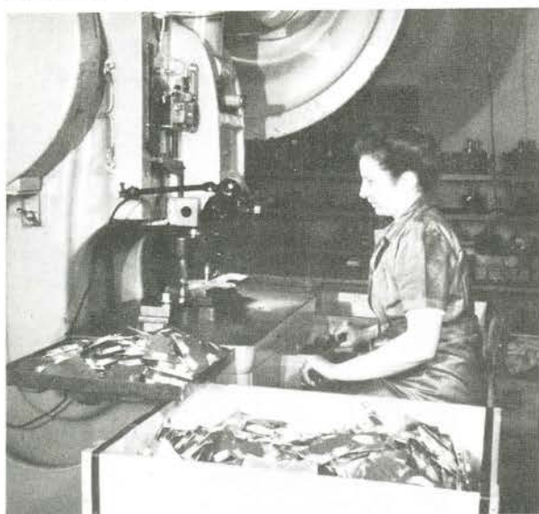
I en excenterpresse optrækkes frontpladen. Flere presseoperationer er nødvendige inden emnet er færdigt. Forskellige værktøjer til pressen ses i baggrunden.
