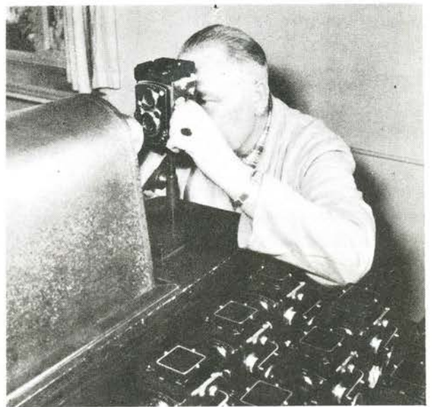
Optisk kontrol, hvor operatøren har taget en metskive på filmplanet og betragter motivet med en lup.
