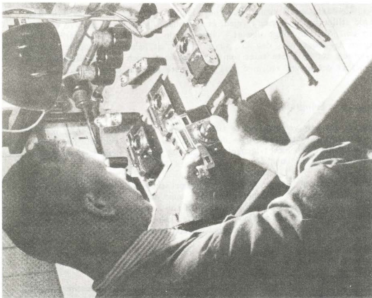
Med måleværktøj afprøves fatningen til Contax-objektivet. Den store præcision under fabrikationen, sætter en tekniker på den anden side af jordkloden i stand til med øjeblikks varsel at reparere en Contax ved at erstatte én del med en anden.
