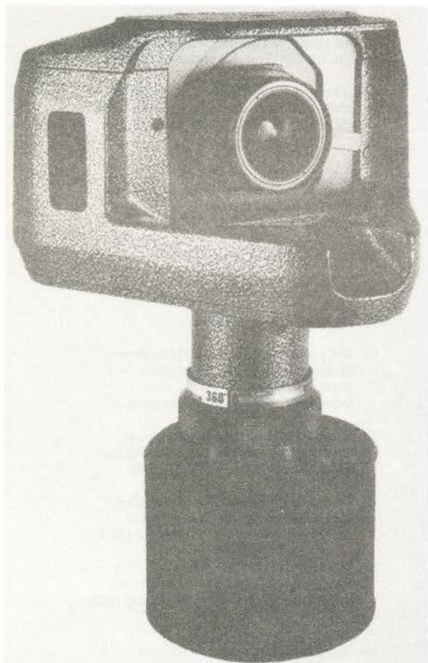
Alpa-Rotorama 6070. Schweiz. Kamera for 45°-360°. Objektiv Grandagon 6,8/75 mm Rodenstock. Lukkertid 15/250. 220 Film eller 70 mm perforeret film. Ca. 1983.
