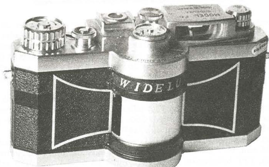
Widex F8. Objektiv Lux f:2,8/26 mm. 140° format 24 x 59 mm på 135 film. 1/15, 1/125, 1/250 sek. Pris ca. kr. 9.000,-
