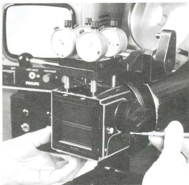
Kontrol af matskivens anlægsflader ved hjælp af måleure.
