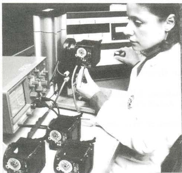
Justering af 2000F spaltelukker ved brug af oscilloskop.
