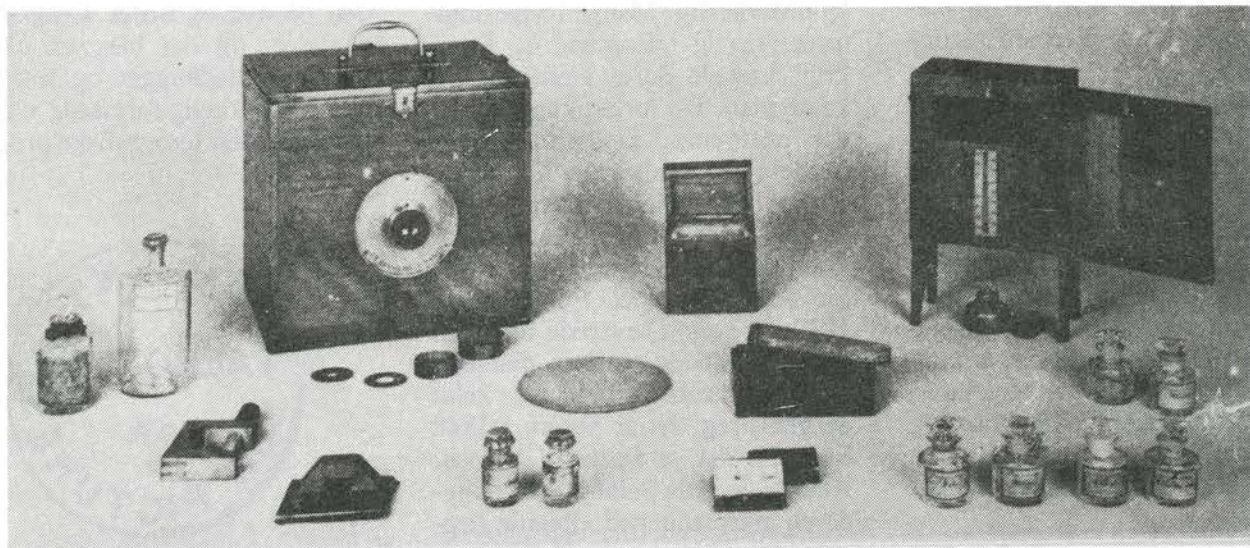
Komplet daguerreotypiudstyr fremstillet af Lerebours, Paris ca. 1840. Har tilhørt Gaudin.
