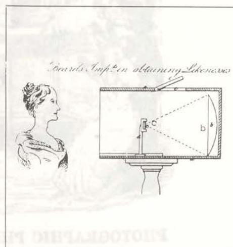
Wolcotts kamerakonstruktion: (a) kamerahus, (b) konkavt spejl, (c), lysfølsom plade. Skitse fra 1841.
