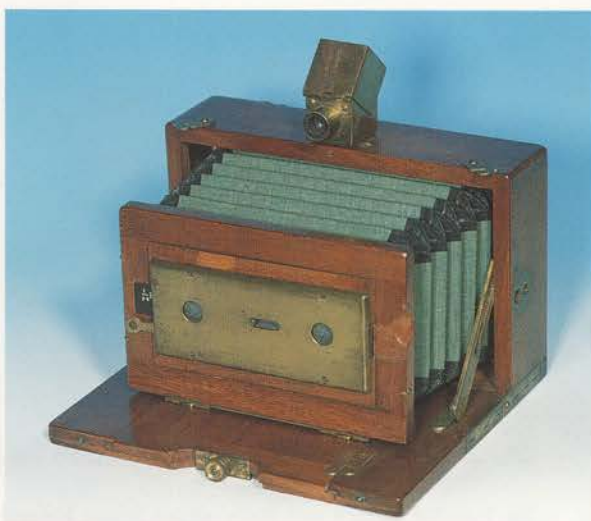
J.P.A. nr. 273. Til dette kamera er der to objektivbrætter - et med monooptik og et med stereo. Pladeformat 12x16½ cm.
