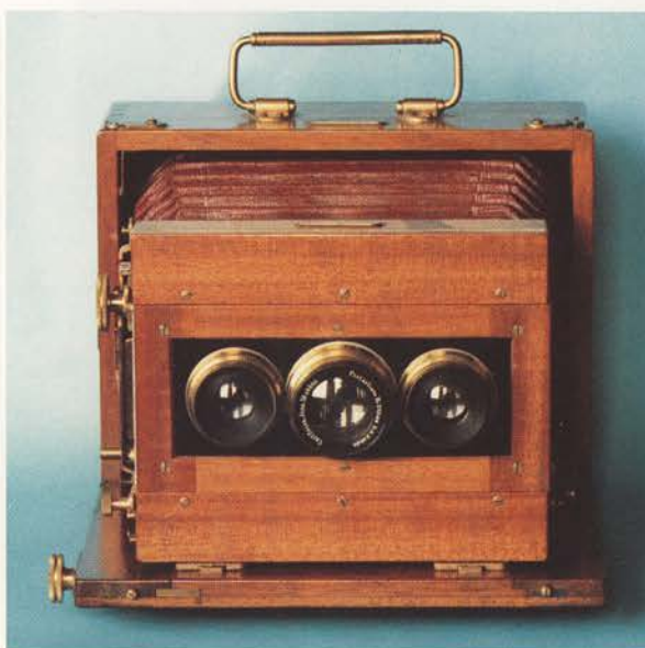
J.P.A. mono- og stereokamera nr. 252. Alt efter hvilke objektiver der afdækkes kan der fotograferes såvel mono, som stereo med dette universalkamera.
