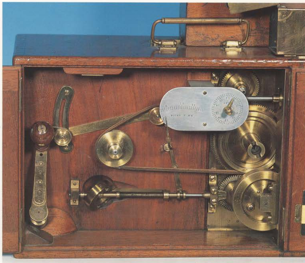
Øverst: Nærbillede af J.P.A. kinooptager nr. 280. Dette apparat er færdiggjort omkring 1905, og er absolut det ypperste af Jens Poul Andersens arbejde. Bemærk bærehåndtaget. De fleste af J.P.A.-kameraerne er forsynet med tilsvarende håndtag. Forneden ses optageren fra venstre og højre side.
