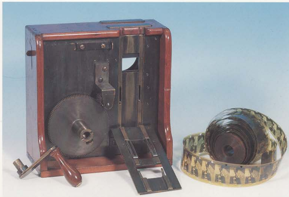
J.P.A. kinofremviser nr. 262. Det er tydeligt at forbilledet er Lumière-optageren fra 1895. Den franske kunne benyttes til såvel optagelse som gengivelse. J.P.A. udgaven her er alene beregnet til at fremvise film. Ved siden af apparatet ses en rulle kinofilm med lumièreperforering - ét hul for hvert billede. Apparatet er forsynet med universalgriber således at der kan køres film med såvel lumière- som edisonperforering.
