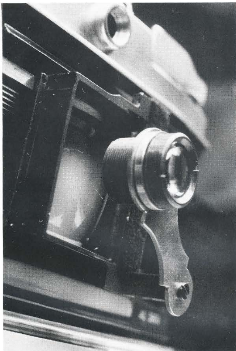
Kalibrering af fokusringen ved hjælp af en matskive i filmpladet.
