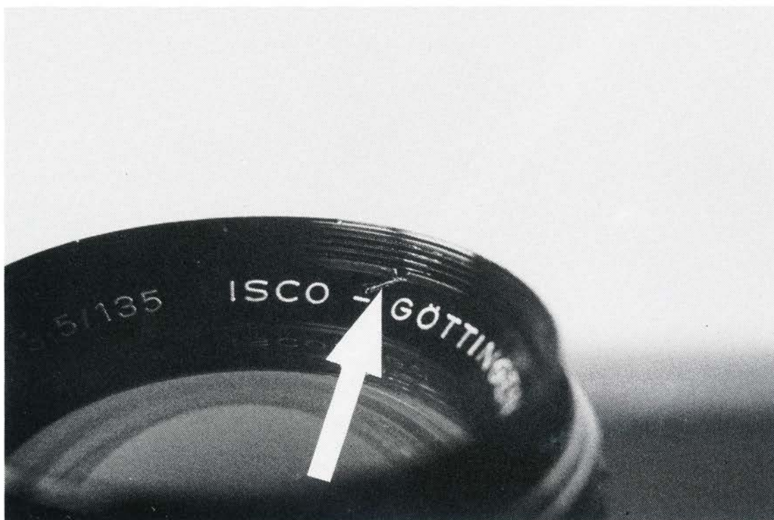
En mindre, men dog uoprettelig skade på et objektiv.
