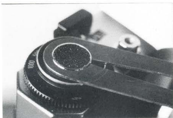
nøgler af messingplade er med til (brug aldrig papegøjetang)
