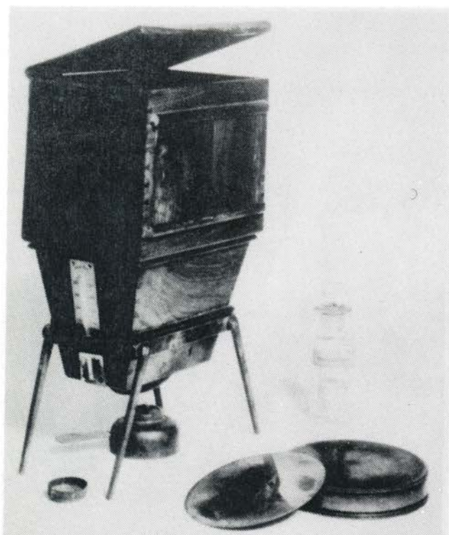
Den lys- og lufttætte fremkalderkasse af træ, hvori Kviksølvdampe skabte det billeddannede daguerreotypi. (Deutsches Museum, München).
