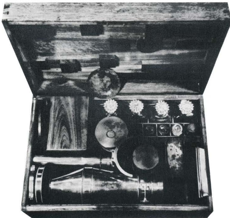
Helmetal-kameraet blev leveret i trækasse med stativ kassetter, plader, joderingsapparat og fremkalderapparat samt kemi. Pris 120 gylden i 1841. Deutsches Museum, München.
