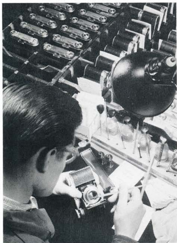
Objektivet anbringes i en Bessa II.
