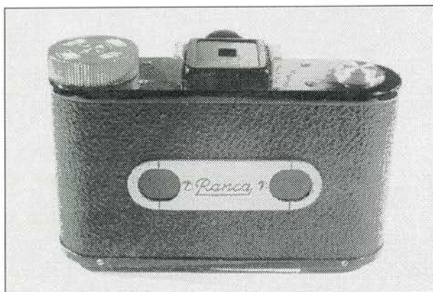
Ranca med navneskilt og de nødvendige to ruder til aflæsning af numrene på dækpapiret.
