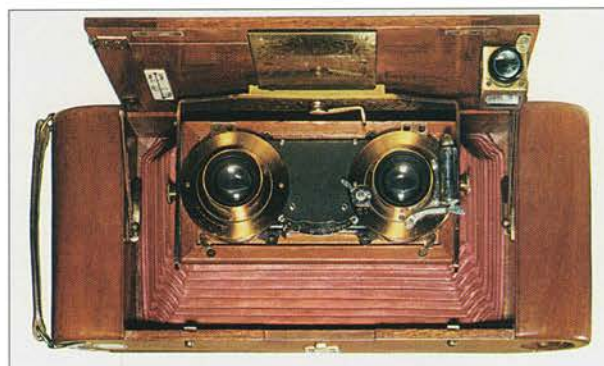
Challenge stereoskopisk teaktræ's kamera. Format 9x12 cm. 1904.
