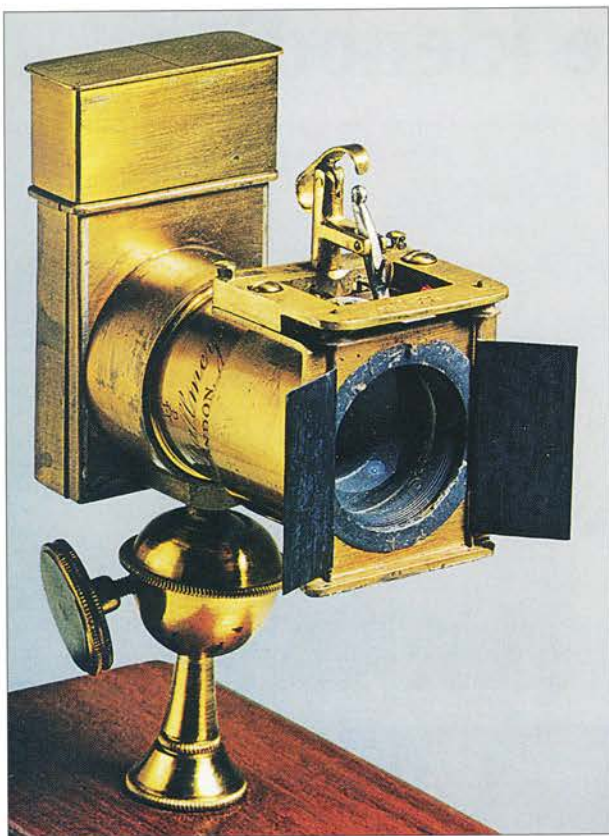
Englænderen Thomas Skaife konstruerede i 1856 en øjebliksslukker til hans Pistolgraph (1860), som havde Petzval objektiv f/2.2 40 mm og f1.1 til 30x40 mm plader. Sammenklappeligt og betjenes fra et påsat kuglehoved. Miniature mørkekammertelt medfulgte.
