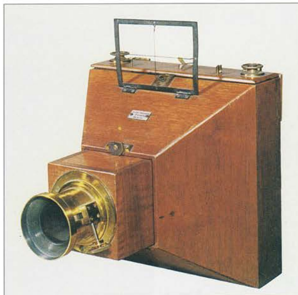
Anschütz-Goerz kamera. Lukker op til 1.000 sekund. 1891.
