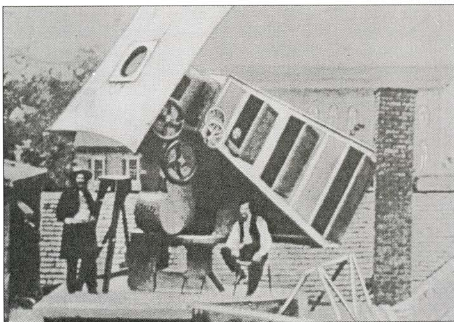
David A. Woodward's solar-kamera fra 1857. Solspejlet er sammenklappeligt.
