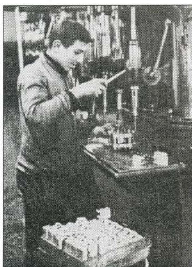
Boring af huller i prismeglashuset.
