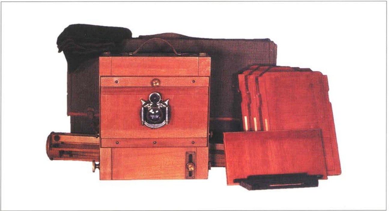
Komplet udrustning til Ernemann Globus K, serie II. Segldugskuffert, stativ og 3 dobbeltkassetter + ekstra stativ, samt skillevæg til stereoskopoptagelser ca. 1896.
