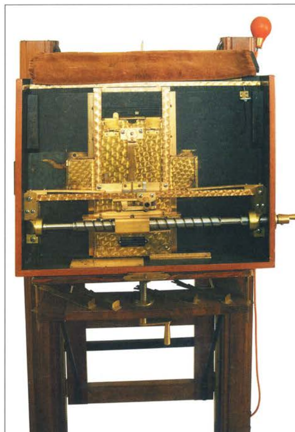
(7) Forkromet spindeldrev med udskiftelig sporskinne, som ved drejning af håndsvinget bevæger sig trinvis, svarende til antallet af spor i skinnerne, fra venstre til højre, ved næste linie fra højre til venstre o.s.v.
