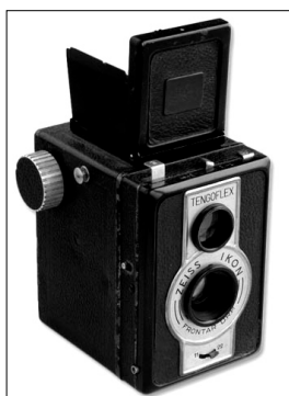
Tengoflex, fremstillet i begrænset antal og kun leveret til Sverige. Luftwaffe Tenax II, énhåndsbetjent, fastlåste tider 1/200 og 1/400 sek., afstand låst fast på uendeligt. Coated Tessar objektiv og gulfilter bag baglinsen.
