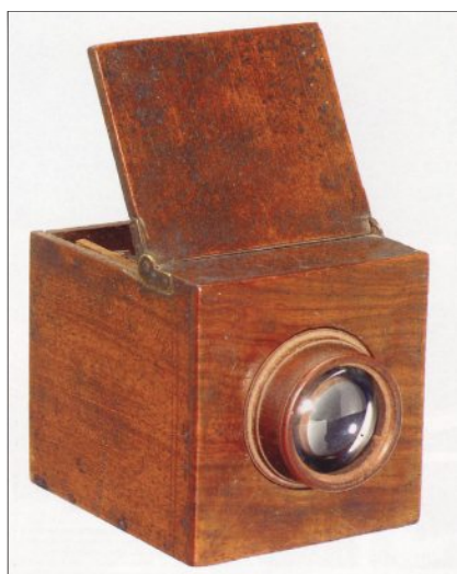
J. Niépce's eksperimentalkamera til optagelse af 'asfaltbilleder', 1825
