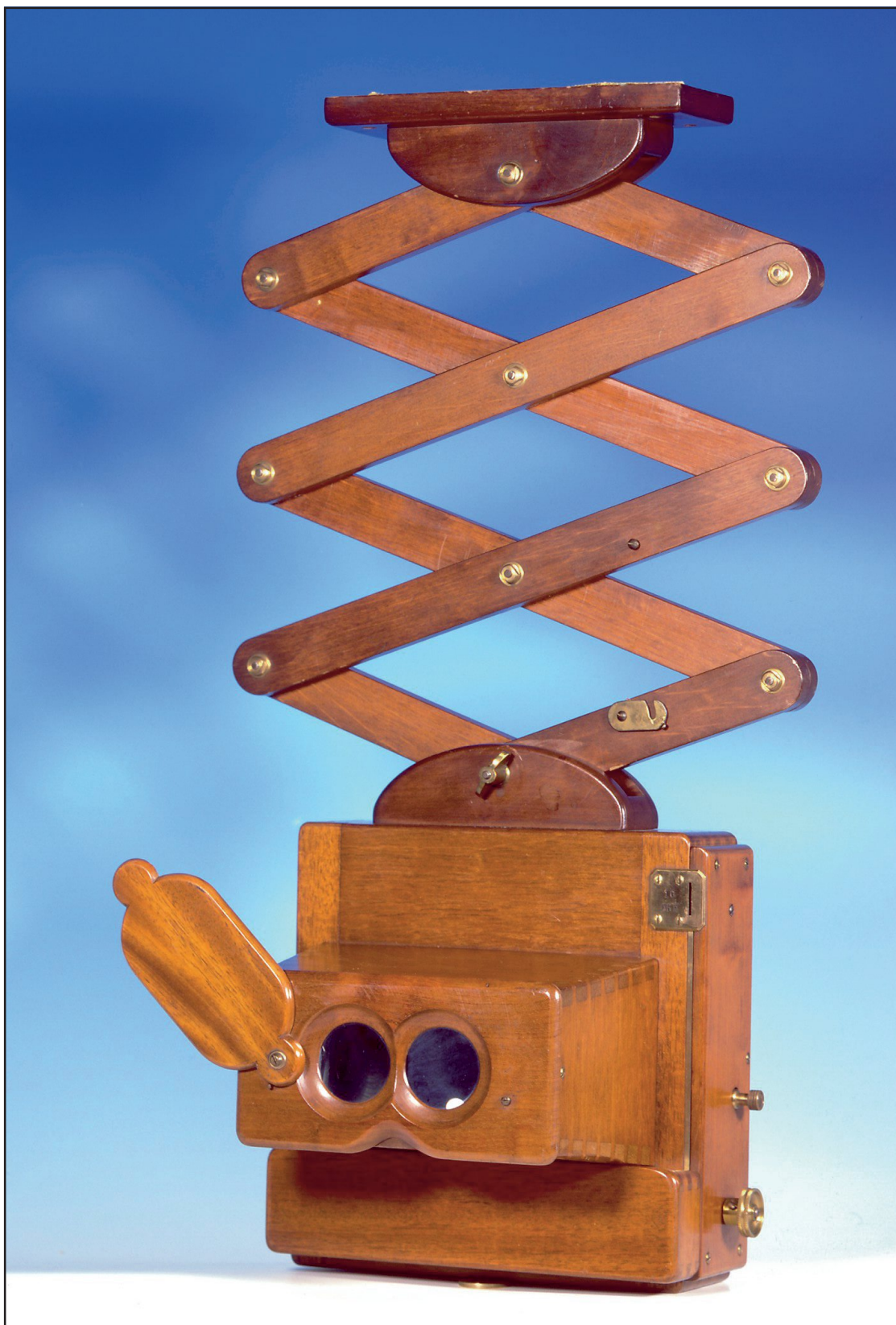
Jens Poul Andersen (Nellerødmanden) konstruerede denne smukke stereoskopbetragter. Med møntindkast og indstillelig 'saksekonstruktion' var en lille forretning etableret, 1925-1930
