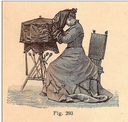
Når rejsefotografen omkring århundredskiftet drog på tur, kunne pladeskift og prøvefremkaldelse være et problem. Ovenstående transportable mørkekammer for rejsebrug, der let kan pakkes sammen som en paraply var en af løsningerne prisen var kr. 30,-
