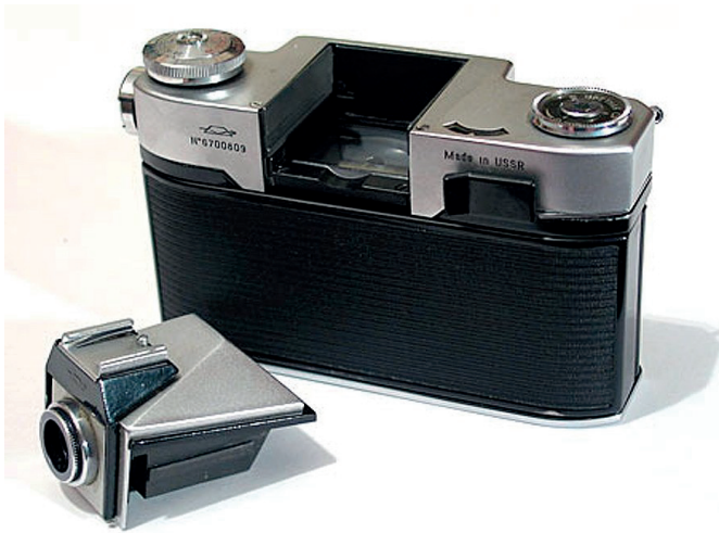
Zenit-4, -5 og -6 kameraerne havde udskiftelig søger (prisme- og skattsøger). Her er kameraet vist med prismesøgeren taget af.
