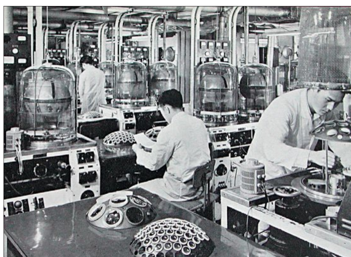
Højvakumsbeholdere får linserne pådampet en tynd antirefleks- belægning
