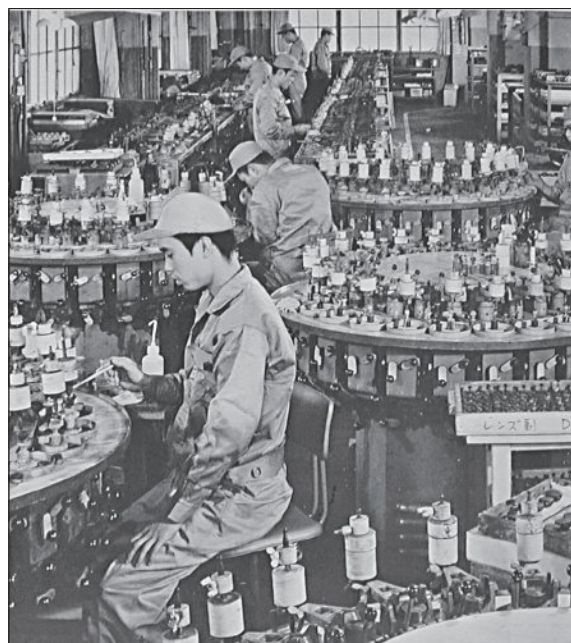
Efter grovslibningen bliver linserne finpoleret
