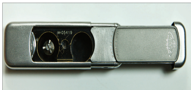
Minox Riga åbnet til filmmagasinet. Filmkassetten er ikke vist
