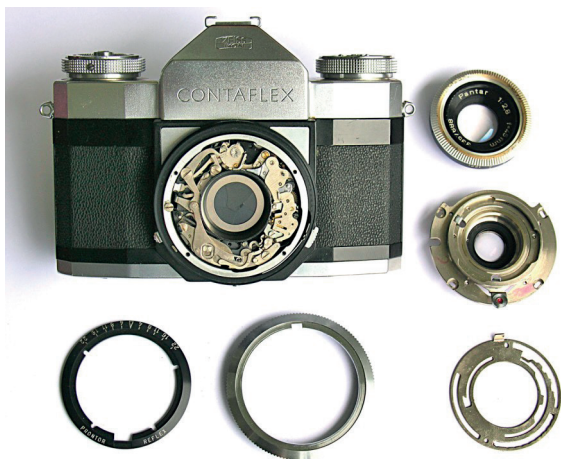
Contaflex Alpha, 1957, et kig ind i Prontorlukkeren
