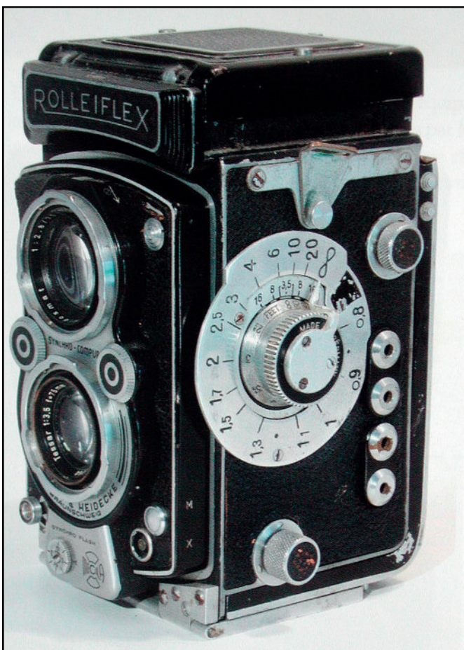
Rolleiflex med stor afstandsskala og modificeret synkronisering.
