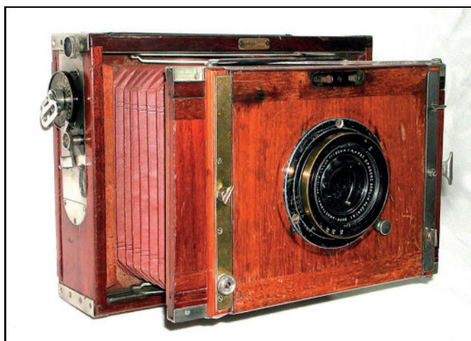
Deckrullo-Nettel, før 1919. Betjeningssiden på Deckrullo-Nettel. C.P. Goerz Doppelanastigmat Celor F=180 mm 1:4,8
