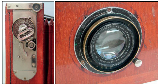
Deckrullo-Nettel, før 1919. Betjeningssiden på Deckrullo-Nettel. C.P. Goerz Doppelanastigmat Celor F=180 mm 1:4,8
