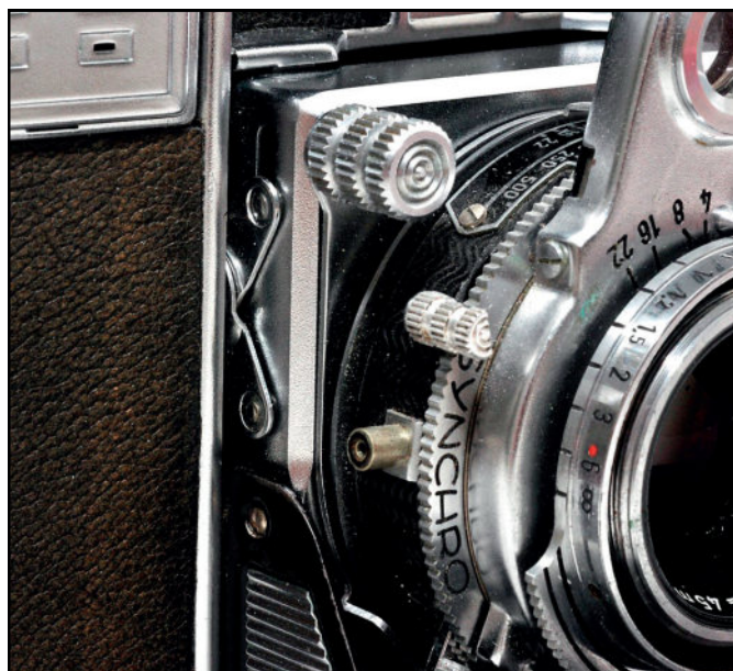
Sakseformede stivere (Spreizen), objektivfront og lukkeren på Contina 35.
