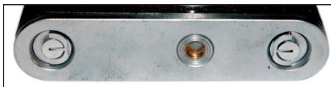
Her er vist FED-2 præ-serie kameraets bund. Bemærk de to åbнемekanismer i siderne. De anvendtes på de tidligt producerede kameraer.
