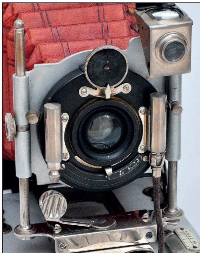
Kameraets front med den pneumatiske Delta lukker.
