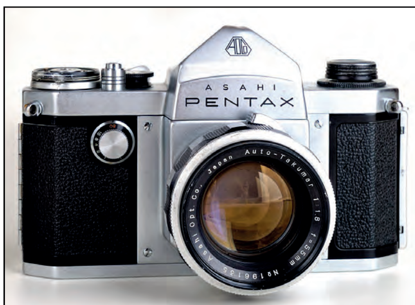
Pentax K med Auto-Takumar 1,8/55 mm. Den udvendige pal til spænding af springblenden ses tydeligt ovenpå objektivet.
