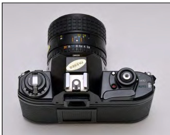
Blikket oppefra afslører de få betjeningsselementer. Drejeknappen nøjes med indstillingerne B, M90 og AUTO.
