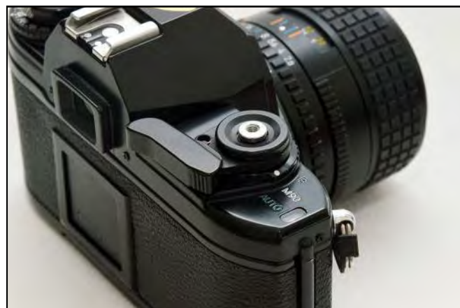
Blikket oppefra afslører de få betjeningsselementer. Drejeknappen nøjes med indstillingerne B, M90 og AUTO.
