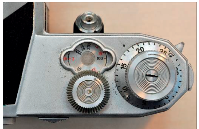
Fremtræksknap, udløser og lukkertidsindstilling. Når lukkeren udløses, snurrer tidsskalaen rundt under glastruden.
