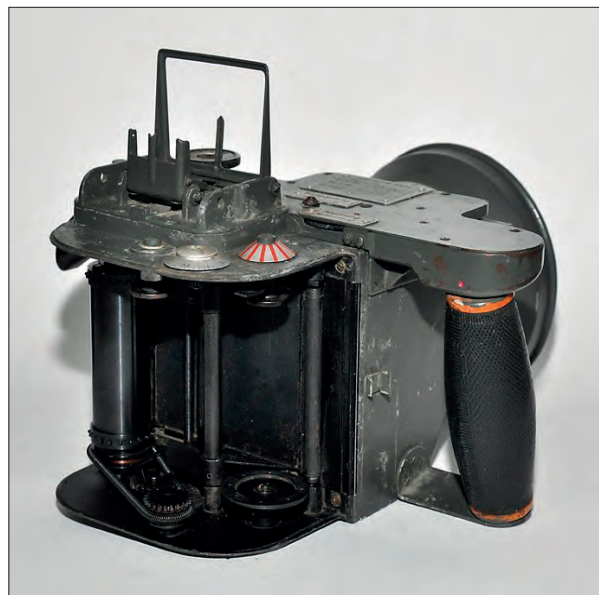
Nederst til højre: Fritz Völk Handkammer Hk 12,5/7x9 med åben filmkammer.
