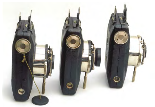
Nacht-Kolibri (midten) kan nøjes med et mindre udtræk pga. den kortere brændvidde. Kameraet til højre har fået en ring af nikkel, for at lette aflæsningen af afstandsskalaen.
