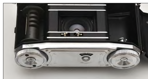
Både fremtræksknappen, returspolingen og tællværket er placeret i bunden af kameraet.
