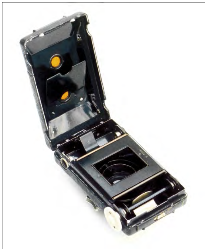
Det åbnede kamera afslører billedruden på 3x4 cm, som er placeret på tværs i kamerahuset.
